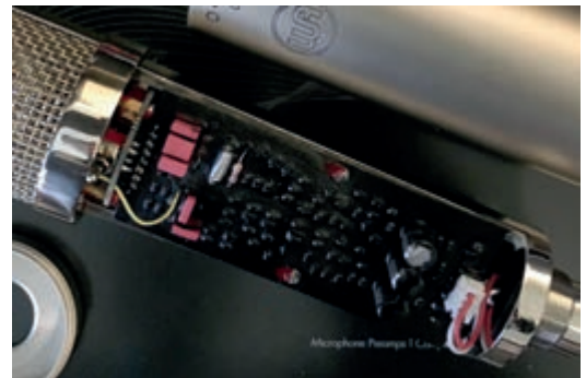
Aufgeräumter „Innenraum“ – die diskrete Schaltung nimmt nur wenig Platz im Korpus des WA-47jr ein; wenig Service-freundlich ist der Harzüberzug auf der Platine
