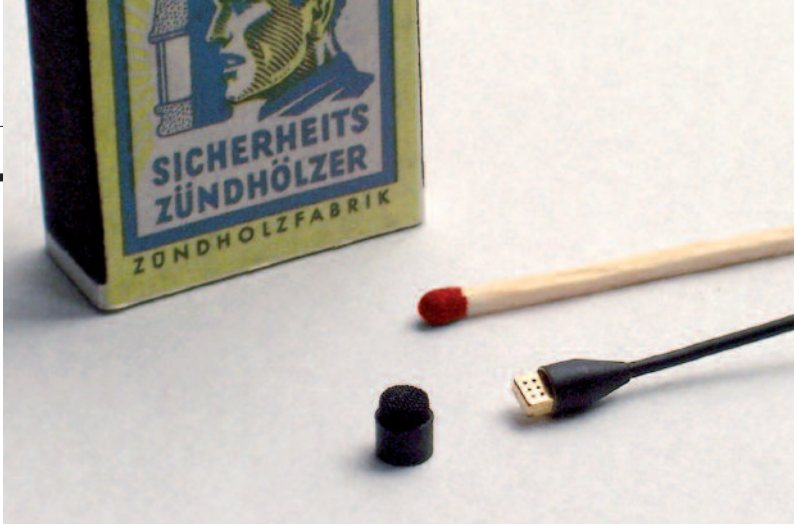
Das komplette Mikrophon ist kaum größer als ein Streichholzkopf. Kurios: Die Kapsel ist stehend montiert!
